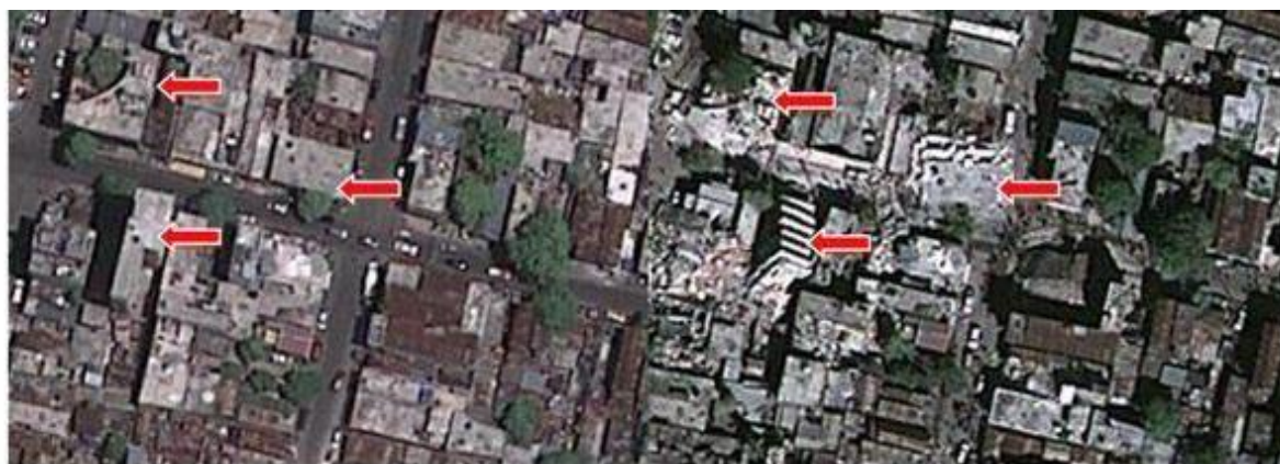
Рисунок 209: Пред- (слева) и послесобытийные (справа) снимки "блинчиков" и "лестничных ступеней" повреждений
