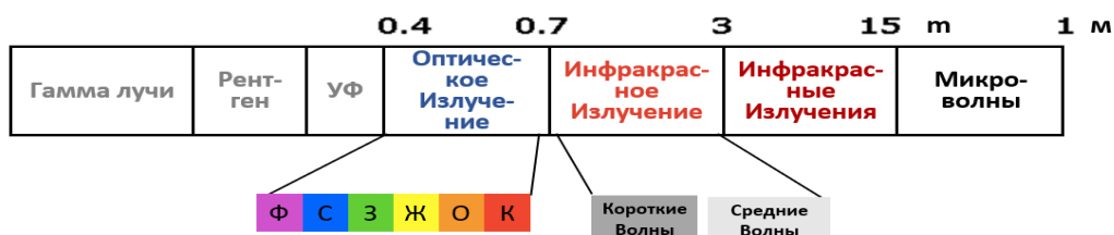
Рисунок 19: Электромагнитный спектр, применяемый в системах дистанционного
