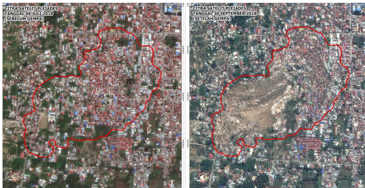
Рисунок 178: Пример использования спутниковых данных для картирования воздействия разжижения в Палу, Индонезия, в сентябре 2018
