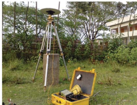
تنظیم مختصات نقاط مرجع در تصاویر با استفاده از فناوری سیستم موقعیت‌یاب جهانی
